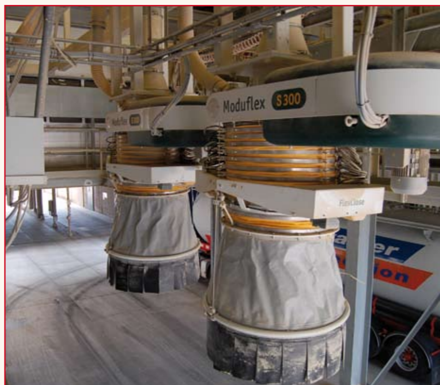
De twee beladingsbalgen met de rok omlaag: perfect voor het vullen van bakwagens
