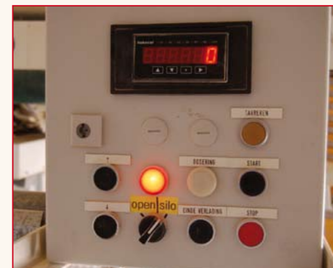
Bedieningspaneel met keuzeknop: open of silo-wagen
